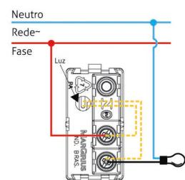
\*Interruptores com luz podem ser ligados com lâmpadas fluorescentes ou de LED somente na condição "lâmpada permanente".
