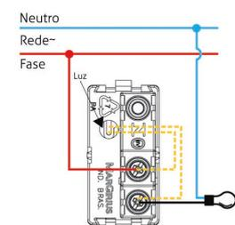
\*Interruptores com luz podem ser ligados com lâmpadas fluorescentes ou de LED somente na condição "lâmpada permanente".
