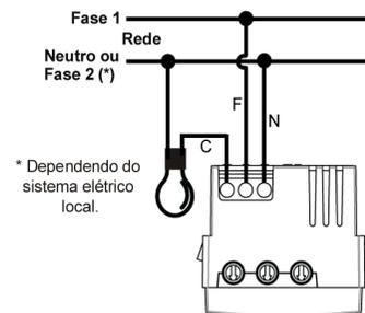
\*Interruptores com luz podem ser ligados com lâmpadas fluorescentes ou de LED somente na condição "lâmpada permanente".
