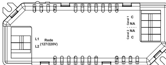
L1 e L2: Terminales para alimentación 127/220V~ | C: Terminales común | NA: Terminales normalmente abierto | NF: Terminales normalmente cerrado.
