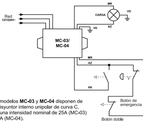
Los modelos **MC-03** y **MC-04** disponen de un disyuntor interno unipolar de curva C, con una intensidad nominal de 25A (MC-03) y 32A (MC-04).
