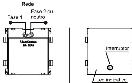
**Led indicativo aceso:** acendimento automático ativo (a luz de emergência acenderá automaticamente em caso de falta de energia).
