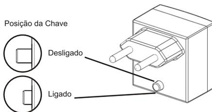
2) Manter a lanterna de emergência MarGirius conectada na tomada com a chave na posição "Ligado" para que a bateria permaneça carregada e para que acenda automaticamente quando houver queda ou falta de energia.
